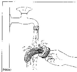
Промойте фильтр проточной водой.
