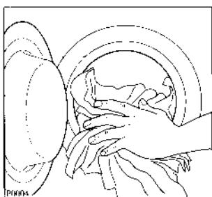
Откройте загрузочный люк нажатием на кнопку открывания люка. Положите бельё в машину по одному и как можно более равномерно. Закройте люк и удостоверьтесь в том, что замок защелкнулся.
