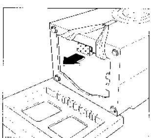
Отверните и снимите правый винт на задней стороне машины, используя для этого отвёртку или гаечный ключ. Наклоните машину назад, не повредив при этом шланги. Удалите поддерживающую двигатель полистирольную прокладку.
