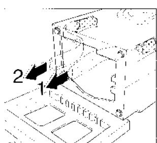
Удалите правый полизтиленовый мешок, осторожно вытянув его по направлению к центру машины (1). Точно так же удалите левый полизтиленовый мешок, вытянув его по направлению к центру машины (2).
